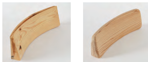
接着・圧縮・曲げ加工 形を整えた椅子背板
