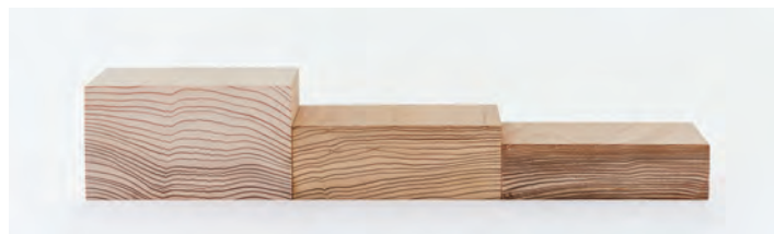
スギ無圧縮材 スギ35%圧縮材 スギ50%圧縮材
